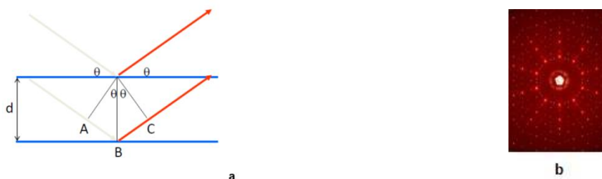
Figura n.º 8 – (a) Lei de Bragg, (b) Exemplo de um padrão de difracção de elevada energia de um único grão de uma liga de cádmio-gadolinio 48 .
